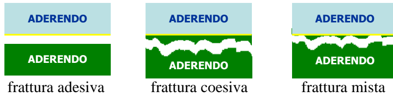
Figura 2-10 – Confronto tra le diverse tipologie di frattura.
