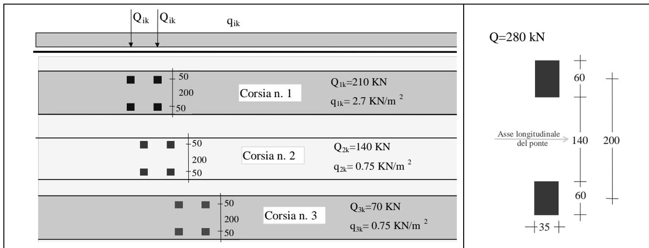
Figura 5.1.4 – Modello di carico di fatica n. 1
