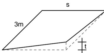
Figura 5.2.14 - Sghembo ammissibile
