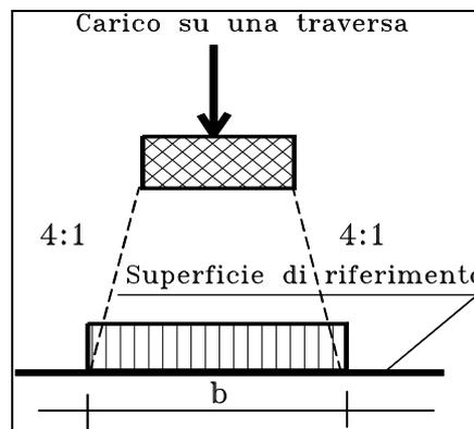
**Figura 5.2.4 - Distribuzione longitudinale dei carichi attraverso il ballast.**
