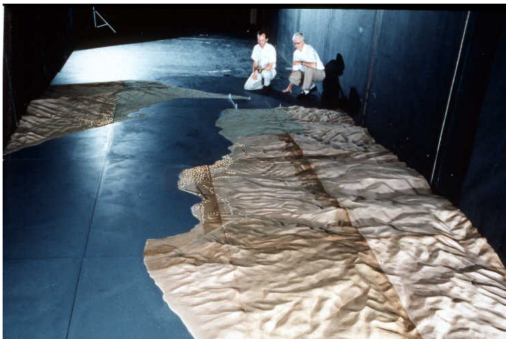
Figura Q.2 – Prova per la modellazione del campo di vento in orografia complessa.
