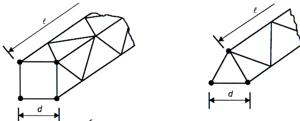
Figura G.43 – Dimensioni caratteristiche dei tralicci.
