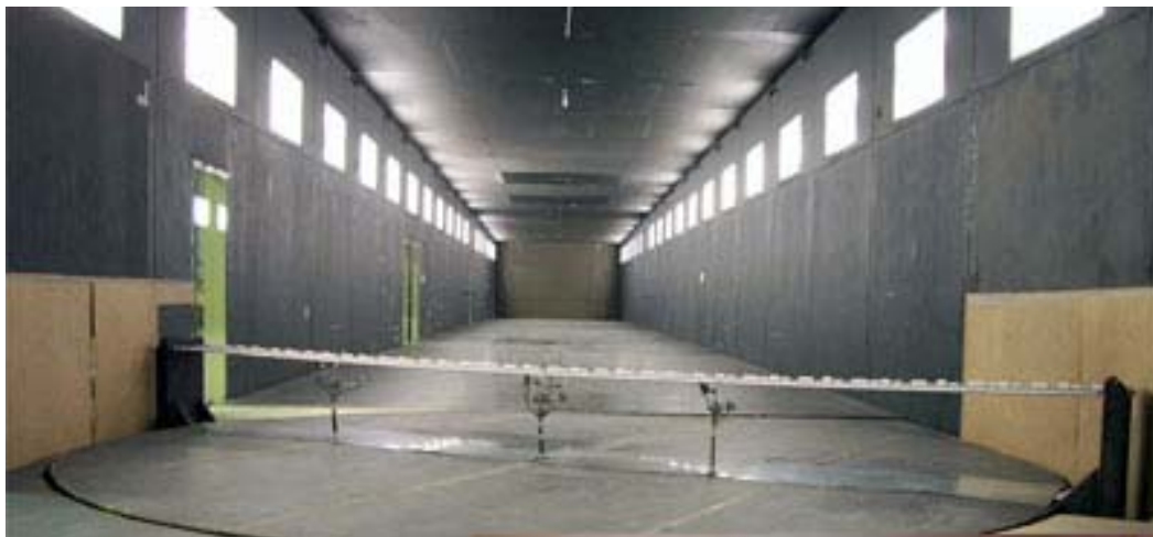
Figura Q.10 – Prova su modello a nastro teso di un ponte sospeso.
