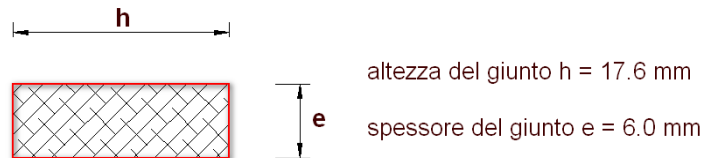
Figura 8.20. Dimensioni del giunto siliconico nell'esempio in esame.
