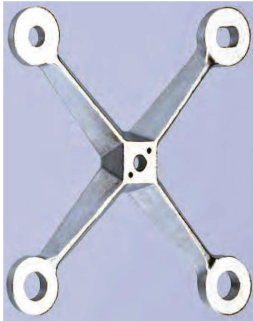
Figura 8.27. Esempio di supporto intermedio di tipo “a ragno”. Si notino le differenti svasature sui quattro fori nelle estremità, per consentire determinati spostamenti ai perni di connessione.
