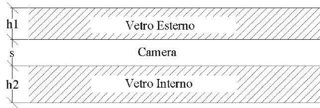
Figura 6.19. Sezione di un elemento di vetro-camera.
